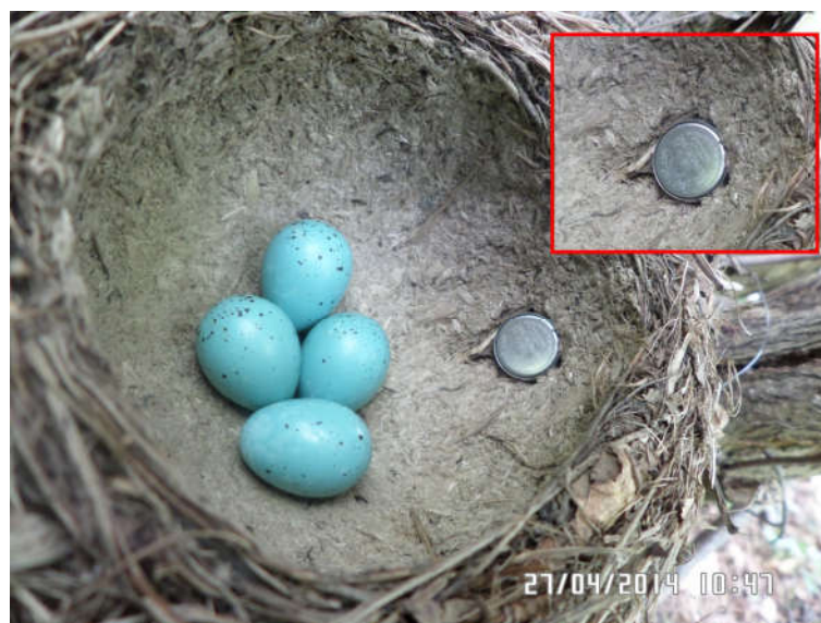
Рис. 2.2 Вигляд вмонтованого логера iBDL-HS у гніздо співочого дрозда
