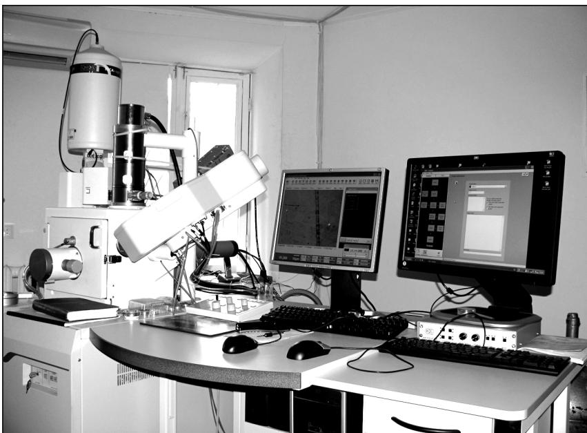
Рис. 4. Сканирующий электронный микроскоп (СЭМ), модель “JSM-6490”.
